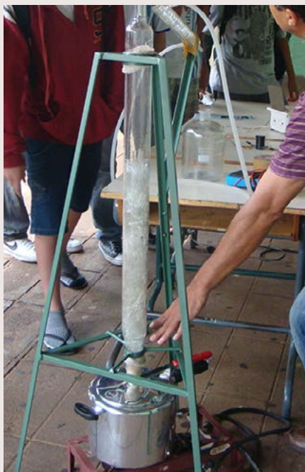
Figura 7 Foto da Micro destilaria de álcool em funcionamento durante a Mostra de Ciências sobre Energia.
